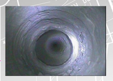
Возможности применения аппарата ПАКТ-04 не ограничиваются малыми диаметрами трубных пучков. На рис. приведены результаты обследования 30-метровой ребристой трубы с внутренним диаметром 100 мм. В данной трубе обнаружено не извлеченное подкладное кольцо.
